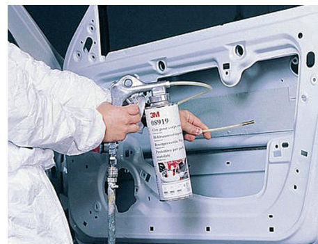
Ci-dessus : traitement corps creux d'un capot Ci-contre : Traitement de l'intérieur d'une porte
